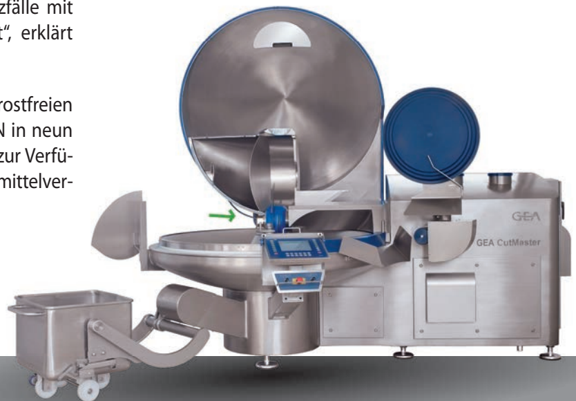
Einbau eines rostfreien FBS-Komplettfreilaufs von RINGSPANN in einem Kutter zur Fleischverbreitung (Bild: GEA)
